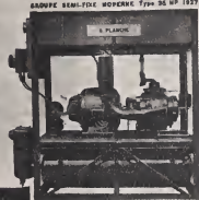
COMPRESSEUR Type 300 NP Assemblage direct avec moteur électrique
